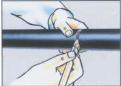
cole as juntas com adesivo Armaflex® 520 S, aderindo também o isolamento à tubulação neste ponto.
